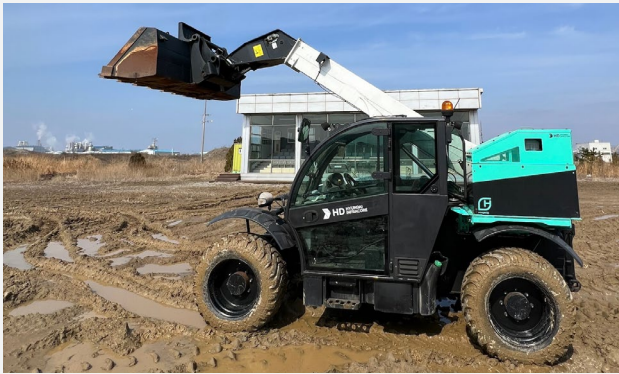
Full Hybrid Powertrain이 적용된 Telehandler 데모 장비
